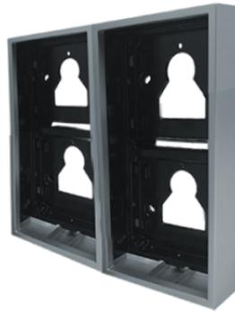
Aufputzgehäuse für Ultra, 2+2 Module. Es besteht aus der Metallhalterung zur Befestigung der Module ohne den Einsatz von Schrauben, sowie dem Rahmen aus kataphoresebehandeltem Aluminiumdruckguss zur Erhöhung der Beständigkeit gegen chemische und umweltbedingte Korrosionsprozesse, einschließlich UV-Strahlen. Überstand von der Wand nur 35 mm. Farbe: silber. Abmessungen: 221x198x35mm.
