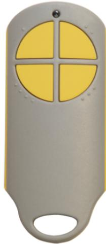
Funksender SimpleKey 868 MHz bi-technology, Key Fob Design. Entspricht der NORM EN 300-220, enthält einen Mifare® Chip der mit SimpleKey Näherungslesern zu benutzen ist, betrieben mit einer 3V CR2016 Batterie, 3 Kanäle: dritter Kanal wird aktiviert wenn 2 Tasten gleichzeitig betätigt werden, ABS Gehäuse mit Gummitasten, Arbeitstemperatur: -20°C bis +50°C, Gewicht: 45g. Farbe gelb. Abmessungen: 65,5x34x13,2mm
