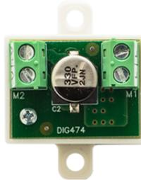
Spannungsadapter für Simplebus2-System. Für den Einsatz in Anlagen mit Netzteil Art. 1210 / 1210A.
