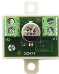
Spannungswandler zum Anschluss von Zusatzkomponenten im System BuildingKit . Maximale Stromaufnahme ist zu beachten und der Tabelle des technischen Handbuch 4681 zu entnehmen.
