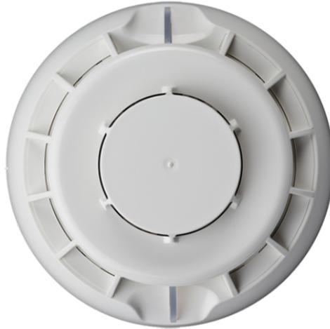
Drahtloser Rauchmelder, RFSMK, der Rauch- und Wärmeerkennung kombiniert. Ausgestattet mit einem Sabotage-Schalter, einer 360 ° sichtbaren LED zur Statusanzeige und einer selbstkompensierten optischen Detektionskammer eignet er sich für den 24-Schutz von Räumen.
