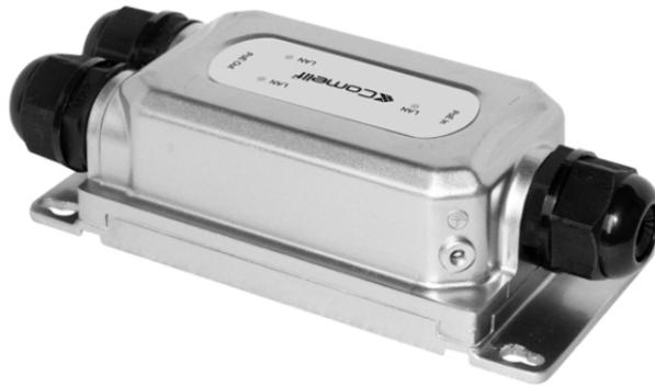
Repeater mit 3 PoE Gigabit 10/100/1000Mbps Anschlüssen, IEEE802.3af/at/bt Standard. 1 RJ45-Eingang 95W max, zwei RJ45-Ausgänge je 30W, Reichweite bis zu 100m. Betriebstemperatur -20°C bis 60°C, wasserdicht IP67, vandalensicher IK10. Mit diesem Zubehör ist es möglich an einer POE Anschlussleitung 2 POE IP Kameras zu betreiben.
