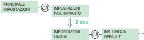
L'inserimento di un nuovo parametro avviene attraverso lo scorrimento dei valori possibili, tramite i tasti numerici.
