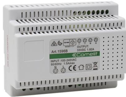
Netzgerät mit 110-230V Eingangsspannung und 33V DC Ausgangsspannung mit 500mA Dauerstrom und 1,2A kurzzeitigen Strom für Lautsprechereinheit der Serie 316 Touch. Ausgestattet mit internen Schutz gegen Überspannung und Kurzschlüsse. Abmessungen: 118x93x60,5mm (6 DIN-Module).
