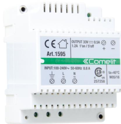
Netzgerät mit 100-240V/50÷60Hz Eingangsspannung und 33V DC Ausgangsspannung mit 500mA Dauerstrom und 1,2A kurzzeitigen Strom für Lautsprechereinheit. Ausgestattet mit internem Schutz gegen Überspannung und Kurzschlüsse. Abmessungen: 71,7x90x62mm (4 DIN-Module).
