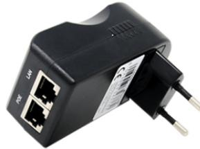
Steckernetzgerät mit Eingangsspannung 100 bis 240V, Ausgangsspannung 48V PoE (Power over Ethernet, Standard IEEE802.3af). Maximale Ausgangsleistung 24W, System ViP.
