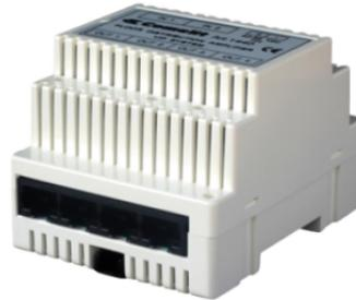
Etagenabzweig (Switch) für das IP-Videosprechsystem zur Weiterleitung der Datenpakete des Comelit ViP-Systems. Ausgestattet mit 6 Ethernet-Kommunikationsanschlüssen mit Comelit PoE (10/100Mbit/s). Art. 1440A regelt die Verbindungsgeschwindigkeit entsprechend den angeschlossenen Geräten und Comelit PoE ermöglicht die Stromversorgung von mehreren Art. 1440A in Kaskade, indem es die Anschlussabstände des Systems im Vergleich zum PoE-Standard verlängert. Abmessungen: 71x89x62 mm (4 DIN-Module).
